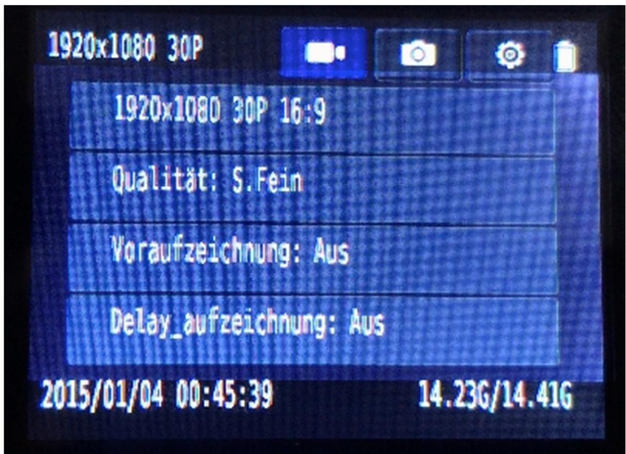
Treffen sie die Menüauswahl durch Drücken der Richtungstasten [▲][▼]. Bestätigen sie jeweils durch die OK Taste 【OK】 . Über die Menütaste gelangen Sie jeweils um eine Ebene zurück bis zum Hauptmenü.
